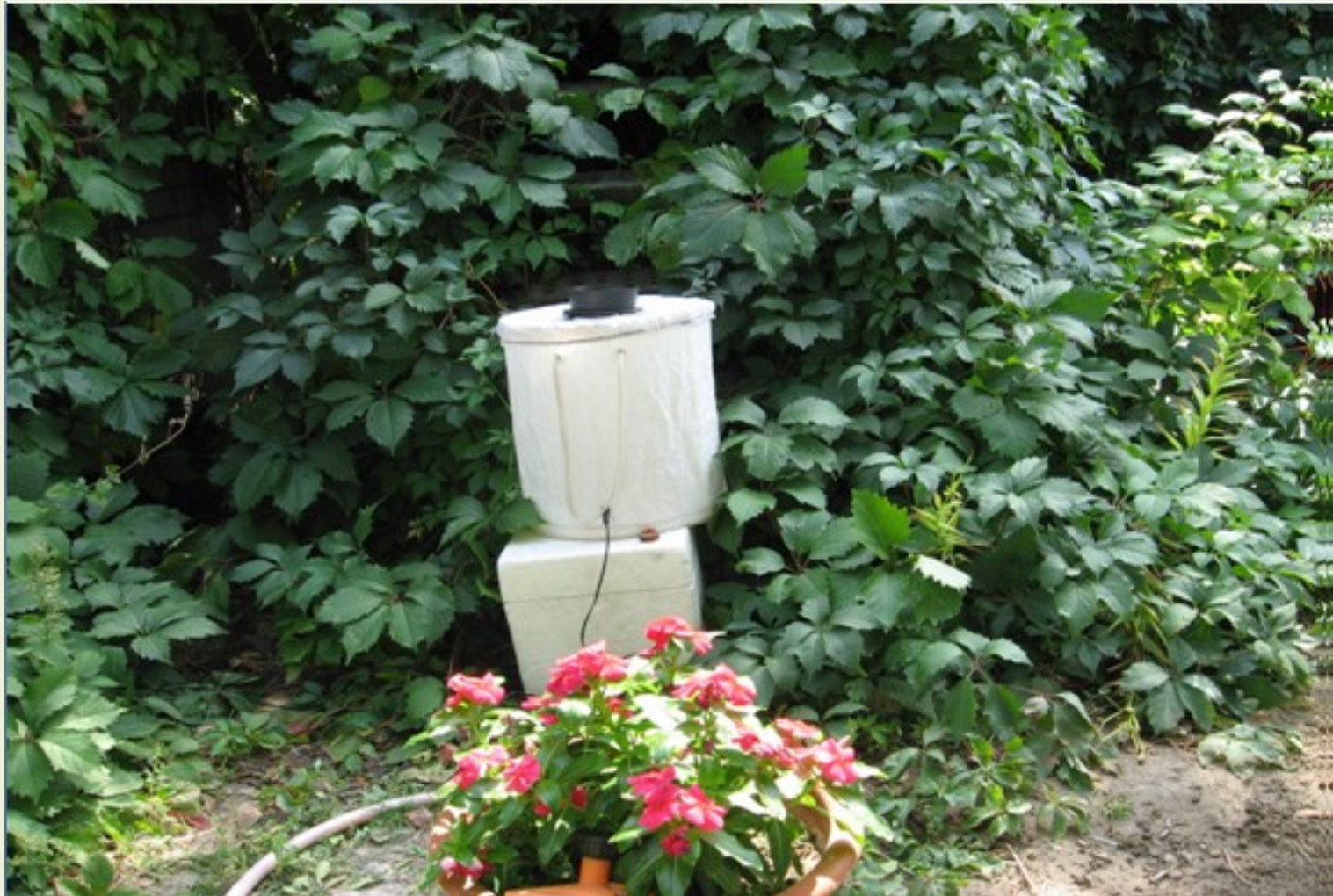
Ловушка VG-Sentinel с сухим льдом (пр-во «BioGents GmbH», Германия)
